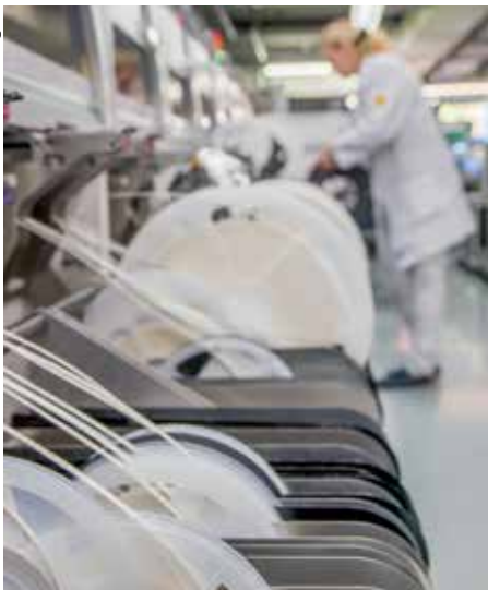
Bauteilrollen auf dem Wechselwagen: Die Bauteilversorgungsstationen (Feeder) werden bei Ihlemann für Tageskontingente von bis zu sechs Aufträgen gleichzeitig vorgerüstet. Die Stillstandszeit zwischen den Aufträgen wird so auf ein Minimum reduziert.
