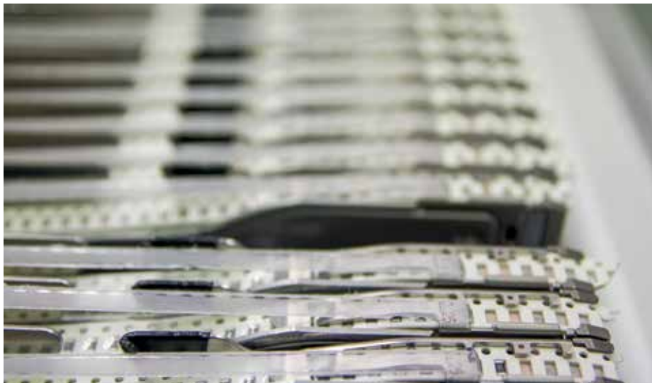
Bauteilrollen auf dem Wechselwagen: Die Bauteilversorgungsstationen (Feeder) werden bei Ihlemann für Tageskontingente von bis zu sechs Aufträgen gleichzeitig vorgerüstet. Die Stillstandszeit zwischen den Aufträgen wird so auf ein Minimum reduziert.
