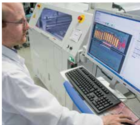
Flying-Probe-Tests: Ihlemann weitet den Einsatz von Flying-Probe-Tests deutlich aus. Die Tests kommen ohne prüflingspezifische Adapter aus und sind durch eine einfache Testprogrammerstellung sehr flexibel einsetzbar.
