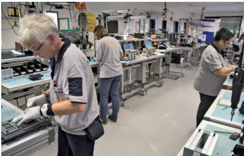
Bild 2. Mit dem Fluss-Prinzip erhöht sich auch die Flexibilität für kurzfristige Änderungen oder variable Losgrößen. Die Rüstzeiten in der Fertigungszelle konnten von 45 Minuten auf durchschnittlich 10 Minuten verkürzt werden.
