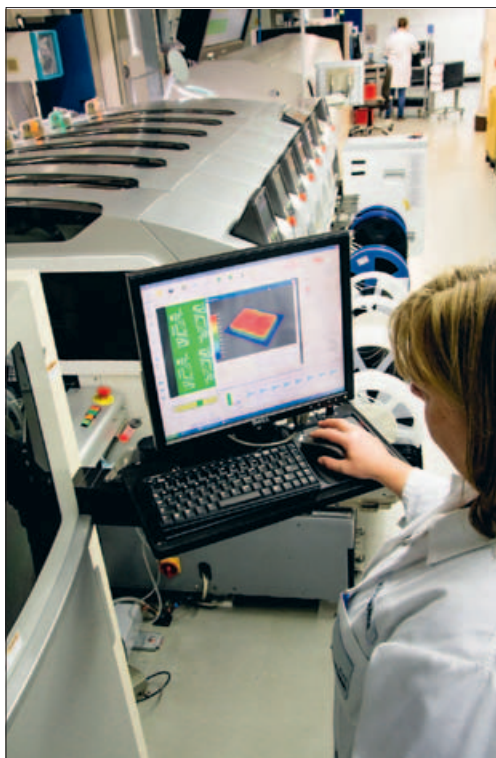
Bild 2. Ihlemann setzt eine Solder Paste Inspection (SPI) in 3D-Technik ein, um beispielsweise kontrollieren zu können, wie exakt ein Pastendepot von 0,25 mm Breite eingehalten wird. (Bild: Ihlemann)
