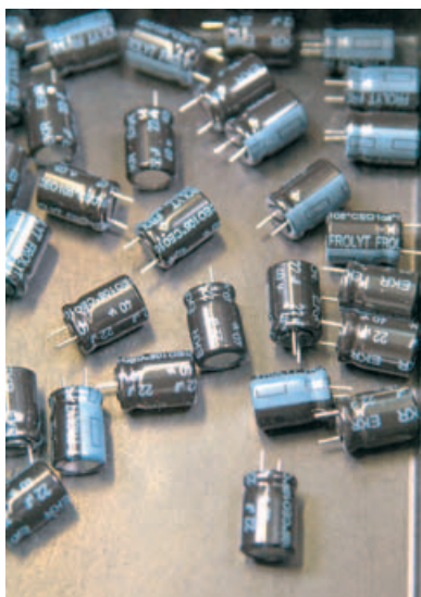
Bild 2. Abgekündigte Bauteile sind bei normalen Bedingungen in der Regel nicht ausreichend lange lagerfähig. (Bild: Ihlemann AG)
