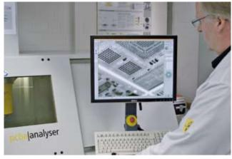
Für die Kontrolle der verdeckten Lötstellen BGAs und zur optimalen Einstellung des Lötprofils nutzt der Auftragsfertiger Ihlemann moderne Röntgentechnik
