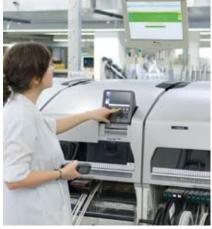
■ Das Bestücken von Multilayer-Boards erfordert Expertise beim Baugruppenfertiger und präzise Ausrüstung, um BGAs mit 1500 Anschlüssen oder SMD-Bauformen wie 0201 und 01005 fehlerfrei zu verarbeiten.
