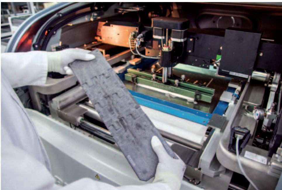
Dünne Leiterplatten müssen für einen fehlerfreien Schablonendruck stabilisiert werden, damit sich das dünne Material beim Druck nicht verformt.
