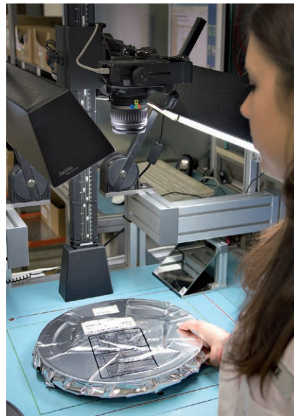
Bild 2: Im Wareneingang erfasst eine Kamera alle Bauteile, eine zentrale Datenbank nimmt sämtliche Daten auf und erlaubt so die lückenlose Traceability aller Bauteile für jedes Fertigungslos
