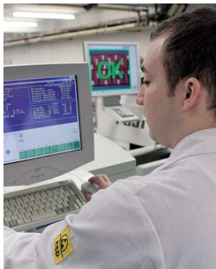
Bild 2: Bereits vor der Bestückung wird bei allen Leiterplatten eine zusätzliche automatisierte optische Inspektion (AOI) des Pastendrucks durchgeführt, um mögliche Lötprobleme frühzeitig zu erkennen.
