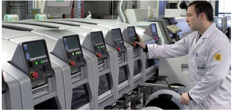
Bild 1: Auf High-End-SMD-Automaten (Multi-Modulbauweise) wird die SMD-Bestückung großer Serien realisiert.
