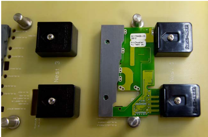
Der neue Testadapter ist als Leiterplatte konstruiert. Damit können moderne SMD-Bauelemente bereits in die Testelektronik integriert werden. Eine mechanische Verdrahtung durch die Drahtwickeltechnik entfällt. Bild: Ihlemann
