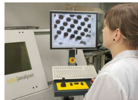
Für die Kontrolle von BGA-Lötungen und zur optimalen Einstellung des jeweiligen Lötprofils wird moderne Röntgentechnik eingesetzt, da Sichtkontrollen hier nicht möglich sind Bilder: Ortgies
