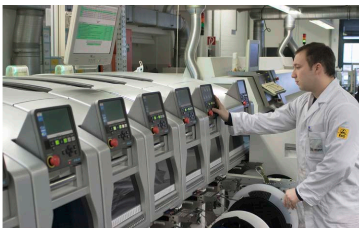
Auf High-End-SMD-Automaten (Multi-Modulbauweise) wird schnell und kostengünstig die SMD-Bestückung großer Serien realisiert
