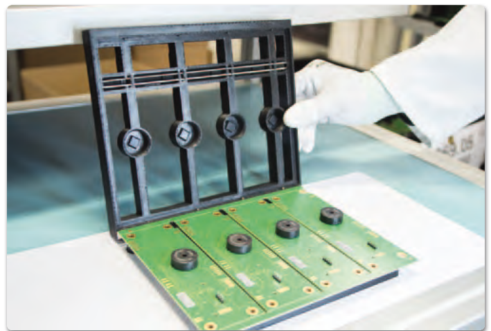
Halterung aus dem 3D-Druck: Haltevorrichtungen aus dem 3D-Druck und integrierte Andruckfedern sorgen dafür, dass die Bauteile beim Lötprozess bündig aufliegen und nicht verkippen können
