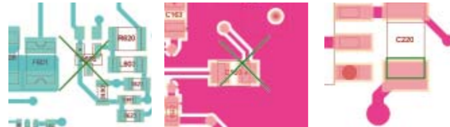
Typische Designfehler bei der Leiterplattenentwicklung (von links nach rechts): Pads unter Bauteil, Pads zu klein, Pads zu weit auseinander Bilder: Ihlemann
