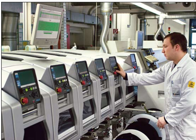
Bild 1: Immer kleinere Bauteile (wie 0402) erfordern hocheffiziente und präzise Fertigungsanlagen und sehr viel Know-how, um die geringen Toleranzen einzuhalten (Alle Fotos: Ortgies)
