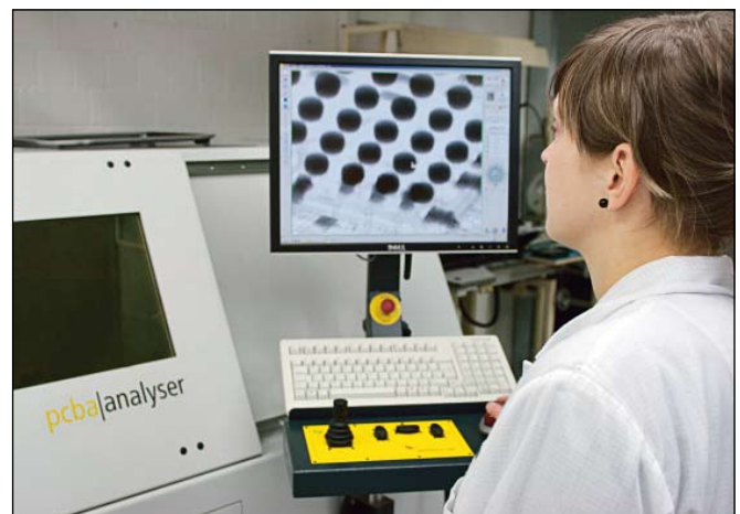
Bild 2: Für die Kontrolle von BGA-Lötungen und zur optimalen Einstellung des jeweiligen Lötprofils nutzt die Ihlemann AG moderne Röntgentechnik, da Sichtkontrollen hier nicht möglich sind
